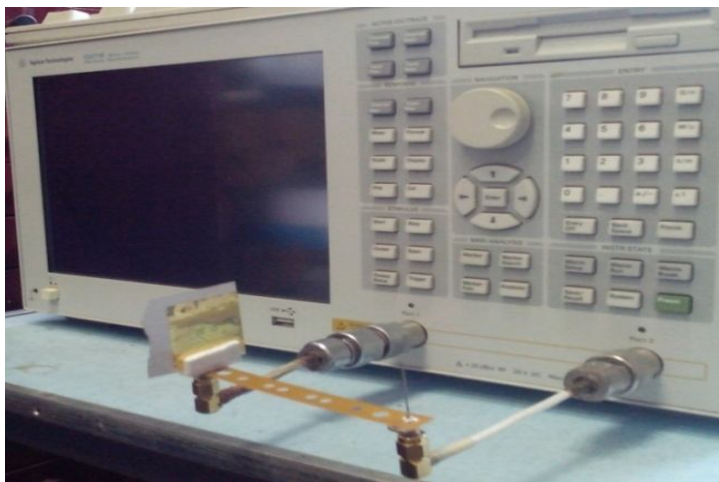
Рис. 1. Измерительный стенд с измерительными антеннами электрического типа и установленным экраном 30х30мм.
